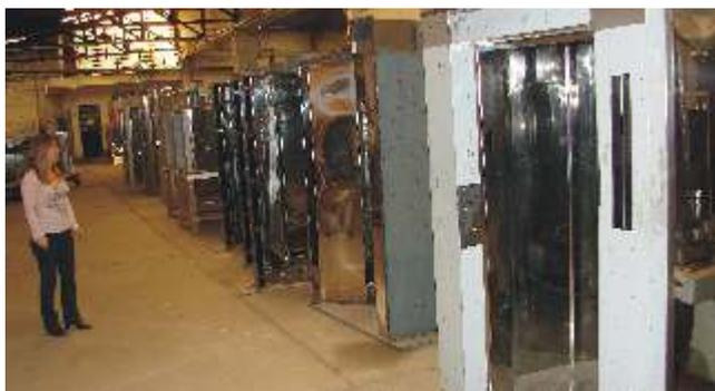
Con respecto a las cámaras de fermentación, Ariana Benigno comenta "...tienen características muy especiales, se diferencian del resto por su aislación, por los equipos de humidificación y los componentes de calor que controlan que los productos mantengan sus propiedades. Están armadas con sistemas modulares para que entren de a dos carros o más..."
