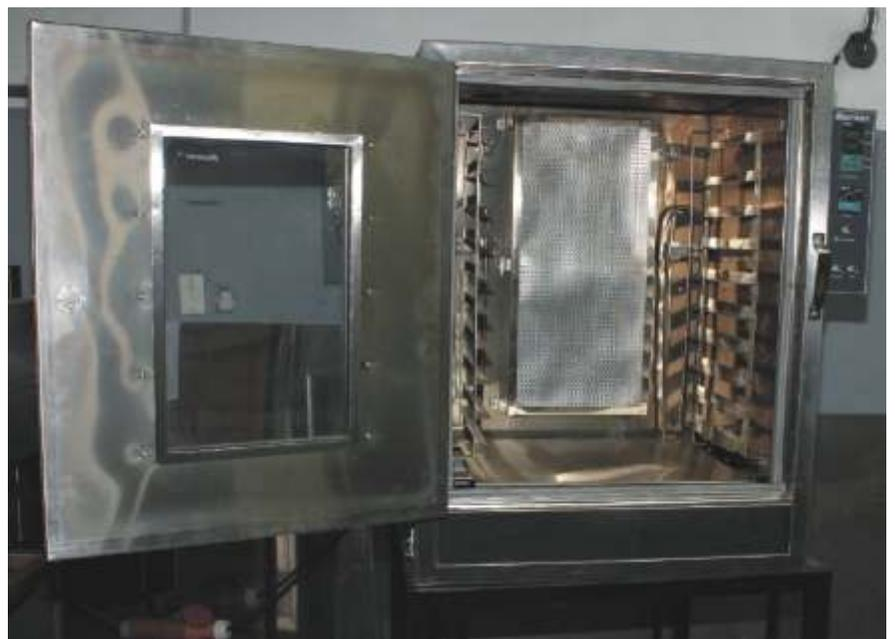
inoxidable de alta calidad, contando con control digital de temperatura, variador de velocidad, doble aislación en lana mineral volcánica, y también quemador a gas automático de alta recuperación.
