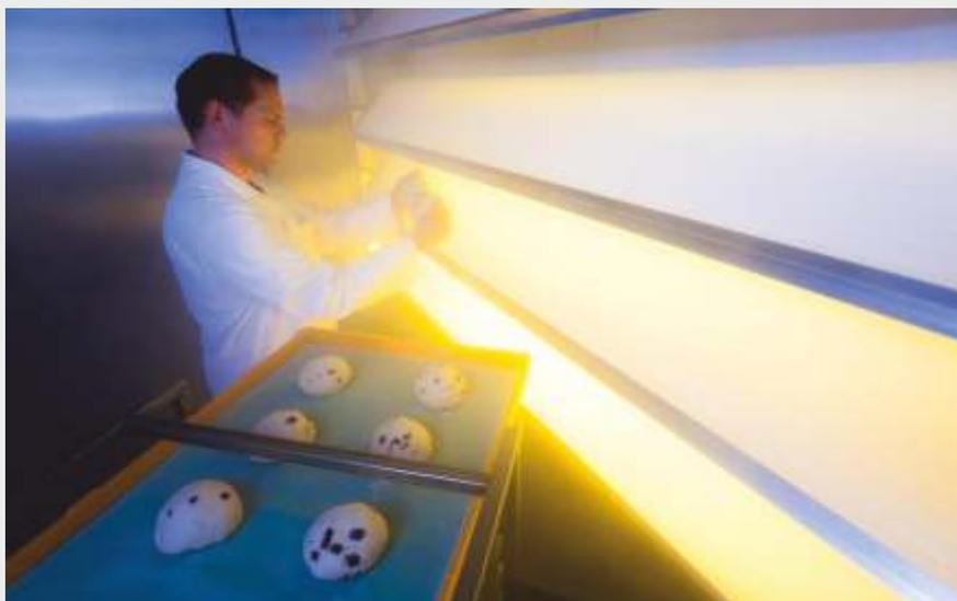
Los responsables del proyecto NanoBAK2 explican que con su tecnología logran generar una niebla de agua fría con gotas que tienen el tamaño de un micrómetro, facilitando mantener un elevado nivel de humedad relativa en la cámara de fermentación que puede alcanzar hasta el 100% a bajas temperaturas, algo que
